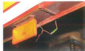
Странно видеть на кузове выставочной машины убогую проводку, грубые сварные швы и ржавчину. А краска на пластике кабины побита камнями; машина пришла из Китая своим ходом
