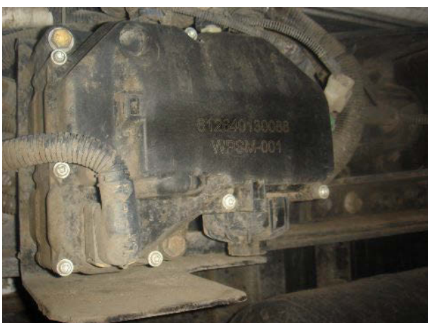
Блок управления подачей мочевины (совмещен с подкачивающим насосом)
