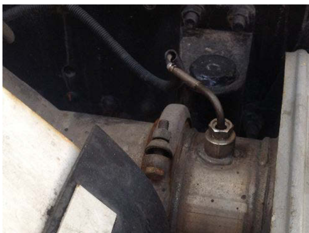
Датчик температуры выхлопных газов устанавливается перед входом в глушитель
