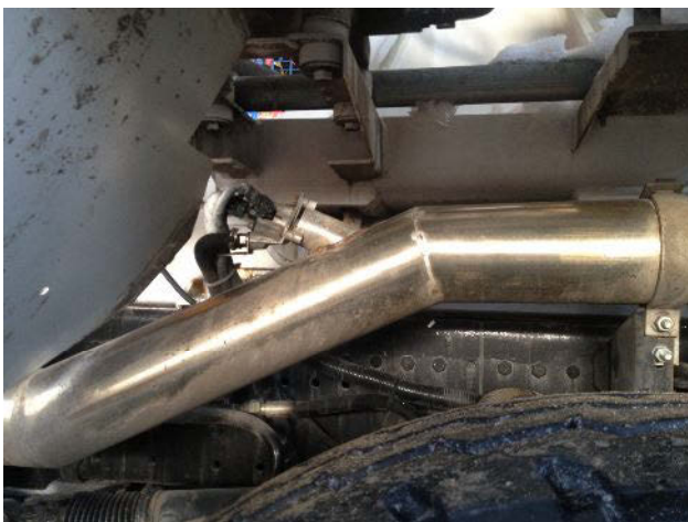
Форсунка для впрыска мочевины устанавливается перед температурным датчиком
