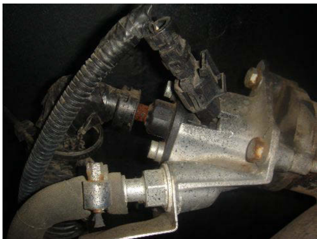
Подогреваемая форсунка для впрыска мочевины
