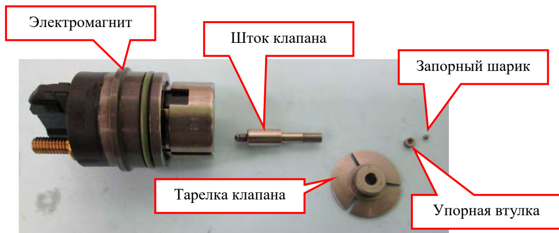
Фото 6. Управляющий клапан с электромагнитной катушкой.
