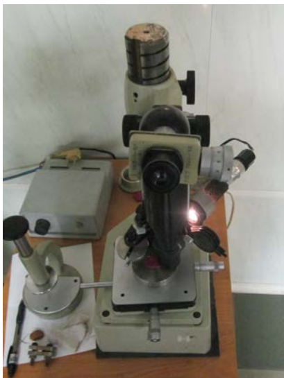
Фото 10. Измерение твердости на микротвердомере ПМТ-3.
