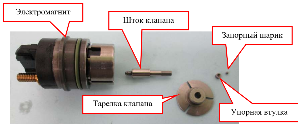
Фото 6. Управляющий клапан с электромагнитной катушкой.
