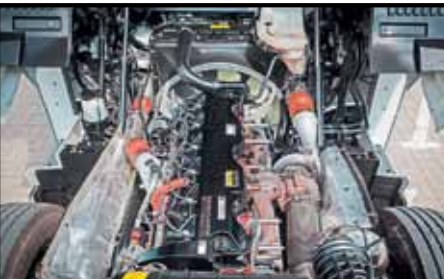
Практически все моторы «китайцев» – рядные «шестерки». На этом Foton H5 стоит Cummins ISG12, объемом 11,8 литра
