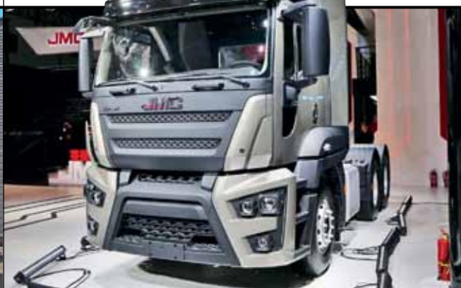
В тягаче JMC Veuron 6x4 очень непросто узнать турецкий Ford Cargo H566. Моторы тоже аналоги Ford Otosan Ecotorq
