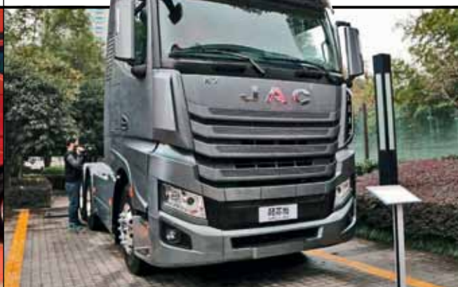
JAC Gallor K7 с мотором MC13, 12,4 л, 540 л.с. Двигатель MAN D26, но выпускает China National Heavy Duty Truck
