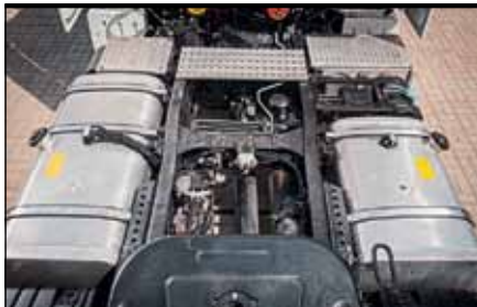
На всех флагманских тягачах стоят алюминиевые баки. Возможный объем баков до 1300 литров
