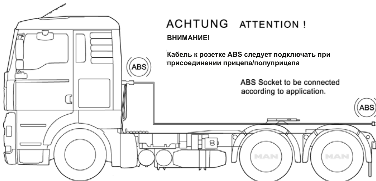
Рис. 3: Подключение соединительного кабеля ABS
